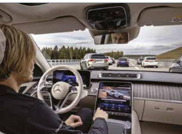
Le niveau 3 d'autonomie peut être enclenché si la voiture roule à 60 km/h sur voies rapides séparées par des terre-pleins. L'an prochain, il pourrait y avoir une évolution au niveau international pour passer la vitesse maximale à 130 km/h.
